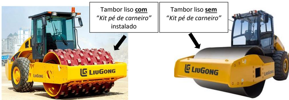
Somente o kit pé de carneiro, de forma isolada, pesa, aproximadamente, 1.600 kg, e pode ser dividido em duas ou três peças, as quais são montadas no cilindro liso com o auxílio de uma máquina para o içamento, devido ao elevado peso de cada uma destas partes. A instalação deste kit demanda várias horas, devido à necessidade de auxílio para o içamento e, também, pela complexidade de sua montagem.
